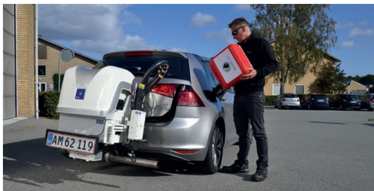
FOTO: Teknologisk Institut afprøver ethanol fremstillet af tang under virkelig bilkørsel. Testen viser, at brændstoffet performer helt på højde med det brændstof, der sælges på tankstationerne i dag.
